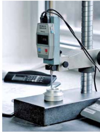
Digitale Messuhr für Höhen- und Tiefenmessung im Tausendstel-Millimeter-Bereich.
