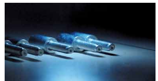
Die Schichtdickenmessung am Fischerscope erfolgt durch die Röntgenfluoreszenzmethode.
