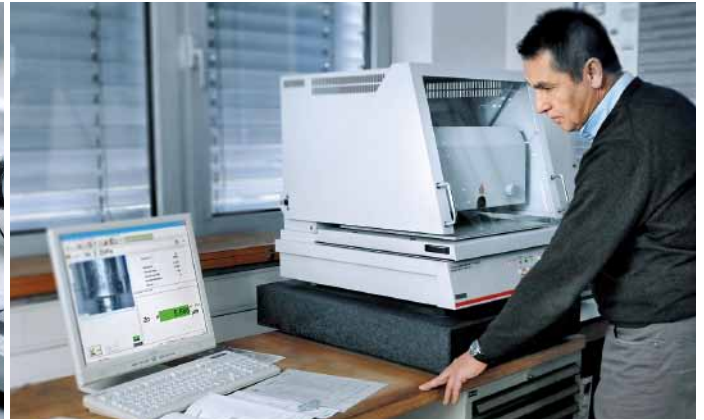
Ein Highlight des Stuttgarter QS-Labors: Das Fischerscope-x-Ray für exakte Analyse der Schichtdicke.
