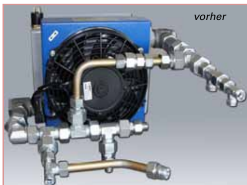
Optimierungen an einem Öl-Luft-Wärmetauscher
