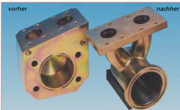
Die alte Ausführung wog 25 kg, die neue optimierte Version wiegt 5,2 kg
